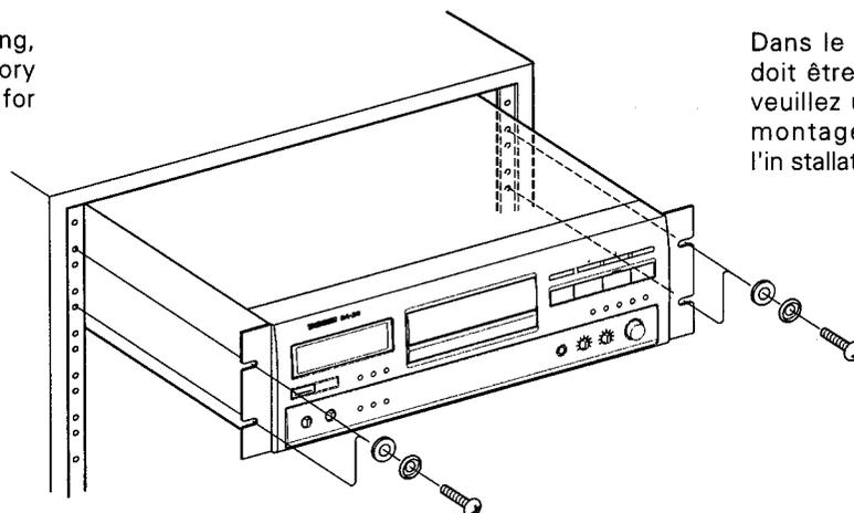
Dans le cas où l'appareil doit être installé en rack, veuillez utiliser les vis de montage fournies pour l'installation.
